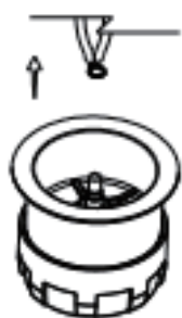
2.1 使用适用于垫圈 10-25mm DIN 5254 的尖嘴钳，将钳臂伸入橡胶圆环的两个孔中，将其取出
